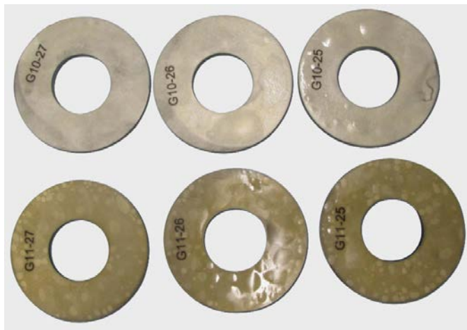
Acción química (H 2 S) en las juntas aislantes de GRE
